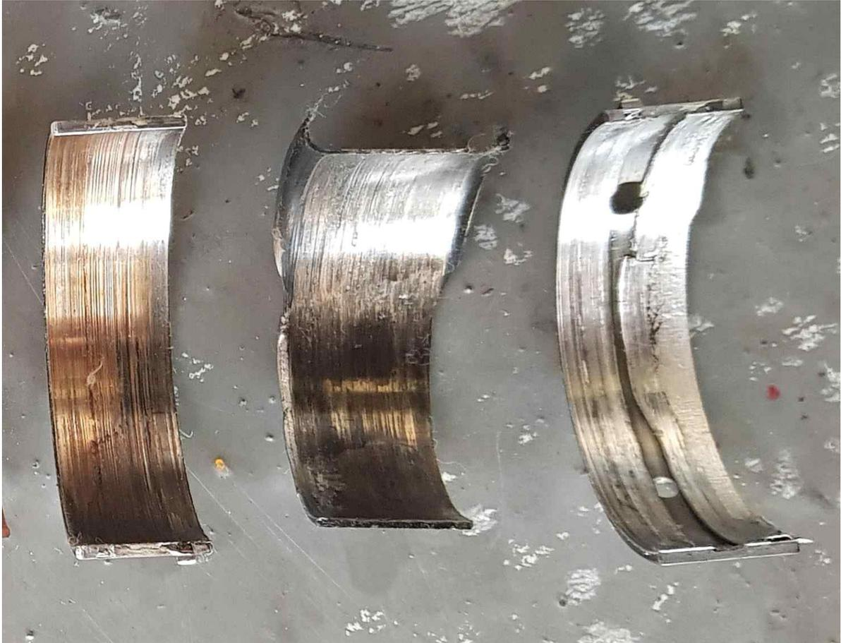
이로 인해 Main Bearing이 Cylinder Block Saddle Bore에서 함께 따라 돌아 Cylinder Block도 손상되었음
